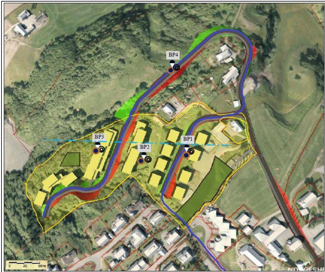
Figur 2: Utklipp av situasjonsplan for lavblokker der tidligere utførte grunnundersøkelser er påtegnet. Fra 20191023G Geoteknisk notat: Nytt boligfelt Gartnerihagen, Løvsetvegen (GeoMidt, 2021). Ny adkomstveg er markert i mørkeblått. Mulig sprengning av fjell er markert i rødt. Planlagte fyllinger for etablering av adkomstveg er markert i lysgrønt. Markerte grunnundersøkelser er fra tidligere rapporter.
